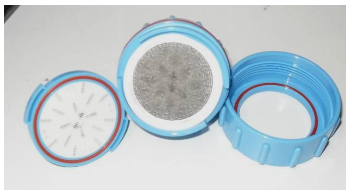
Porte filtre et filtre après une semaine de prélèvement de particules PM10
